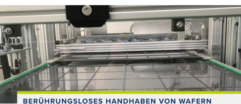
Das Modulare Waferhandling-System ermöglicht sämtliche Prozesse, die bei der Handhabung von Wafern vorzufinden sind. Be- und Entladen, Fördern, Greifen, Inspizieren, Sortieren und Vereinzeln lassen sich in einem System realisieren.
